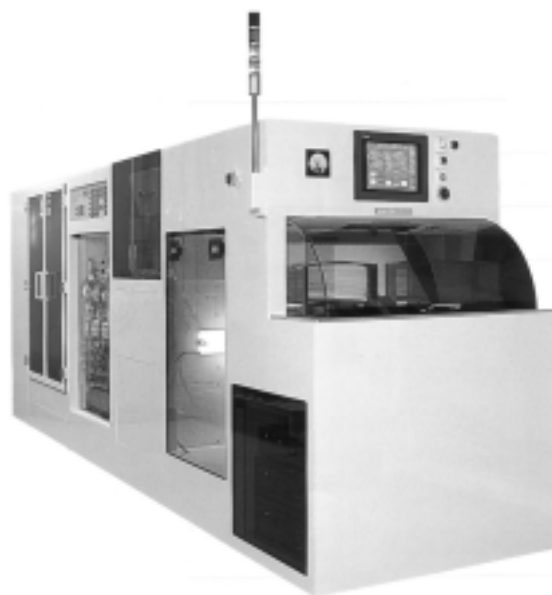
サブミクロンのパーティクルまで非接触で両面洗浄可能なスピンソニッククリーナー
